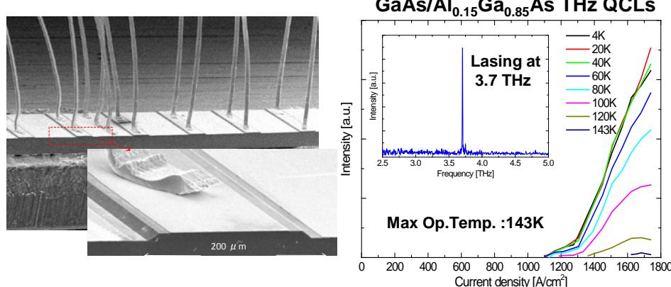
図4. GaAs系テラヘルツ量子カスケードレーザの素子概観と発振動作特性
