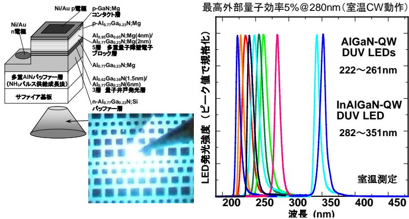
図3. 実現したAlGaN系半導体深紫外LED(波長222-351nm)の構造と動作スペクトル
