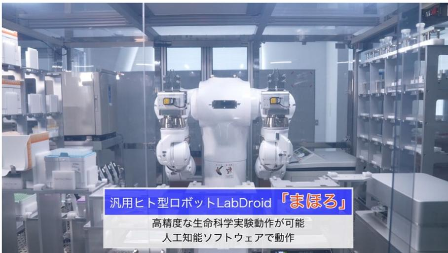
これが、開発した汎用ヒト型ロボット「まほろ」です。まほろに、人工知能ソフトウェアを組み合わせたシステムを開発しました。このまほろに、iPS 細胞を網膜色素上皮細胞へ分化誘導させる際の、最適な培養条件を探させました。
