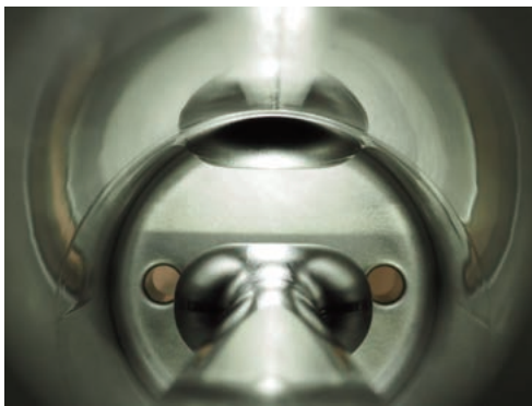
図3 純ニオブ製 加速空洞の内部
