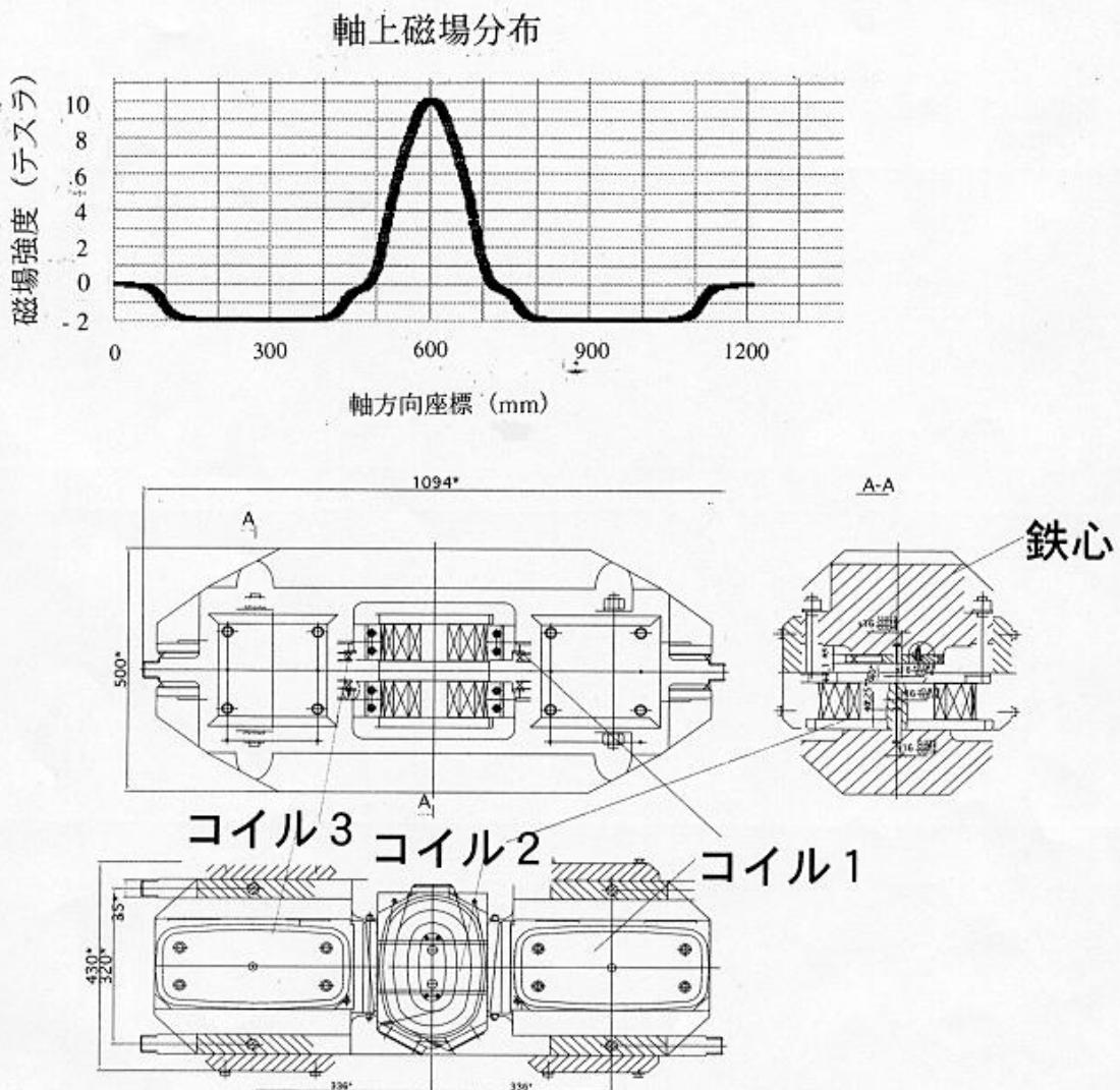
ウイグラーに入射した電子はニオブチタン製の超伝導コイル1によって内側に曲げられる。曲げられた電子はニオブ3スズとニオブチタン製のコイル2の磁場で反対方向に曲げられ、このとき強力なX線が発生する。このX線を色々な用途に利用する。電子はさらにコイル3によって作られた磁場で元と同じ軌道上に戻される。
