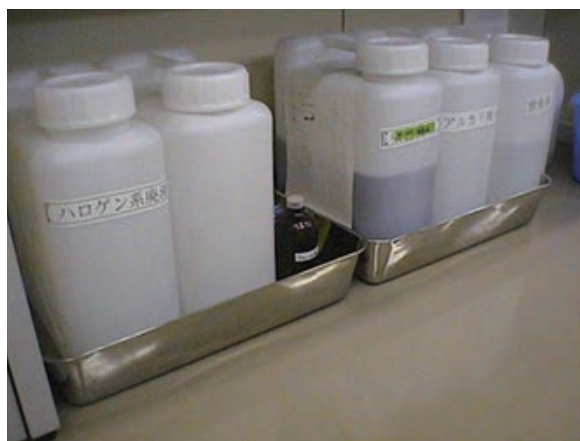
廃液タンクと漏洩防止のトレイ
