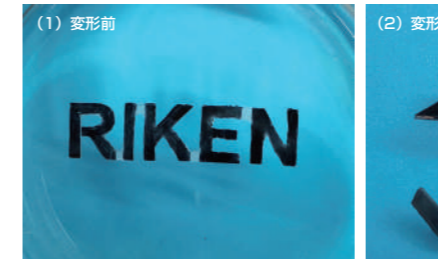
図2 新しい機能性ポリマーの形状記憶特性 変形前のポリマーの薄膜(1)を、50℃の湯の中で軟らかくして変形させ、そのまま室温で冷やすと硬くなって変形した形状を保持できる(2)。それを再び50℃の湯の中に入れると(3)、元の形状が速やかに復元される(4)。ポリマーの薄膜は無色透明なので、見分けやすいように文字の部分をインクで黒く塗ってある。
