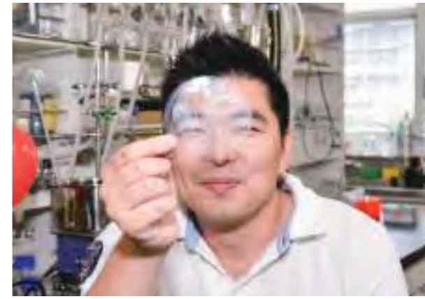
図4 試験管内で合成したクモの糸タンパク質からつくったシート
