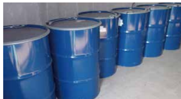
漏洩対策などの措置を行い保管しているPCB含有廃棄物
