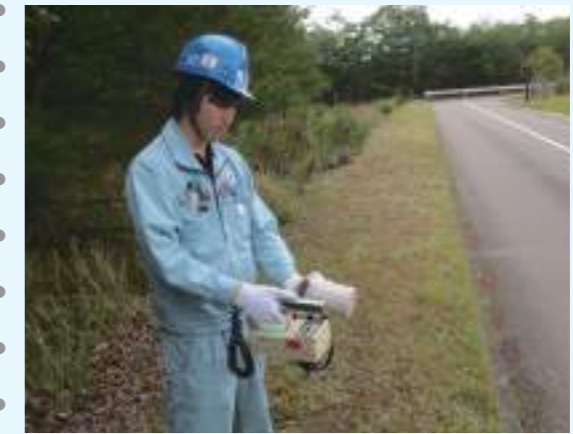
空間線量測定の様子
