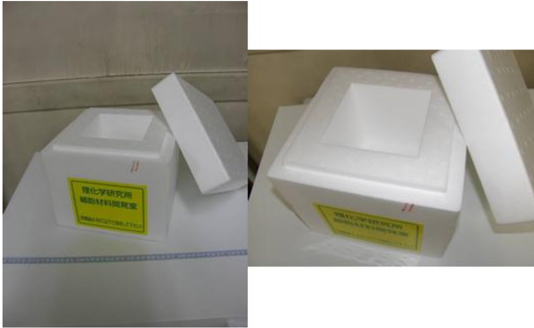
図 3. 発送用発砲スチロール箱。右写真の穴の中に、保存チューブとドライアイスが充填される。
