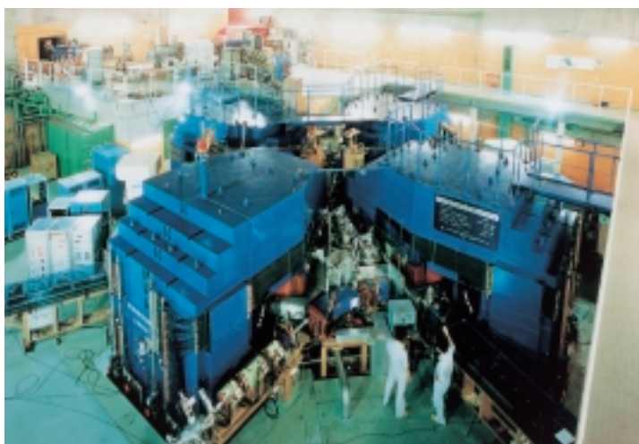
加速器科学の発展に寄与する「リングサイクロトロン」の本体(上)と重イオン科学の要となるRIPS(核反応生成核種分離装置)(下)
