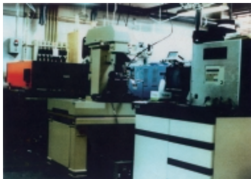
レーザー科学研究 半導体微細加工研究用 エキシマレーザー露光 装置（上） レーザー誘起化学反応 用高出力HBrレーザー （レーザー波長4μm帯、 パルス出力1.4J）（左）
