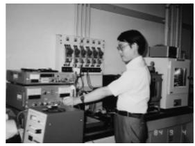
定電位・定電流電解装置
