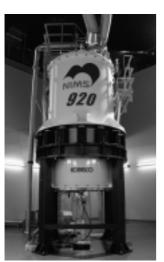
物質・材料研究機構と共同で世界最高の感度と分解能を持つ 920MHzのNMR装置を開発、サンプル濃度が少なくても基本構造を解析することができる
