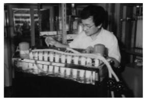
温度可変藻類の培養装置
