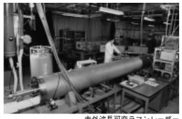
主任研究員) らが16 μ m帯の高出力可変波長 ラマンレーザーを開発した。この成果がレーザー科学特定研究第 II 期の計画を推進する原動力となった。
