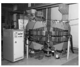
セクター電磁石の4分の1モデルで、リングサイクロトロンの次期計画をアピール
