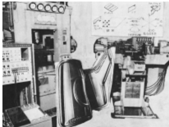
薄鋼板の物性、変形工学研究から実生産に結びつけた大型薄鋼板試験機
