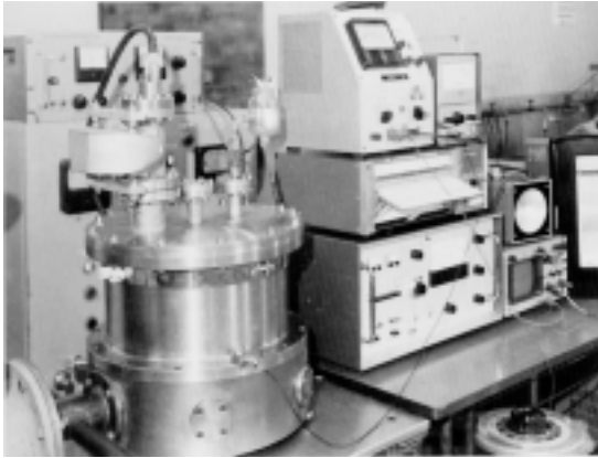
極高真空への道を拓いた軸流分子ポンプ (OV-T650 社内実験中。大阪真空機器製作所)
