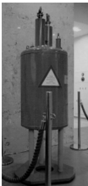
日本で初めてタンパク質構造解析に活用された270MHzのNMR装置
