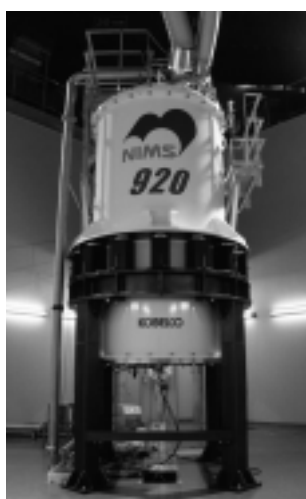
物質・材料研究機構と共同で世界最高の感度と分解能を持つ920MHzのNMR装置を開発、サンプル濃度が少なくても基本構造を解析することができる
