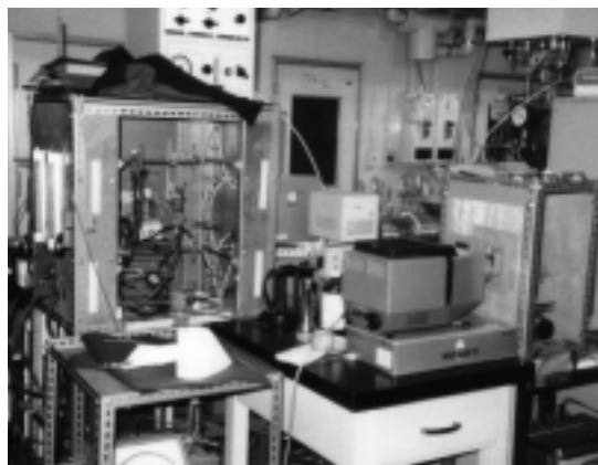
理研グループが自作した藻類ガス代謝測定装置
