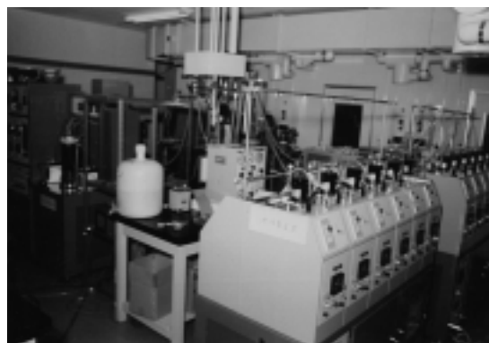
アルガトロンの中の好熱性藻類大量培養装置
