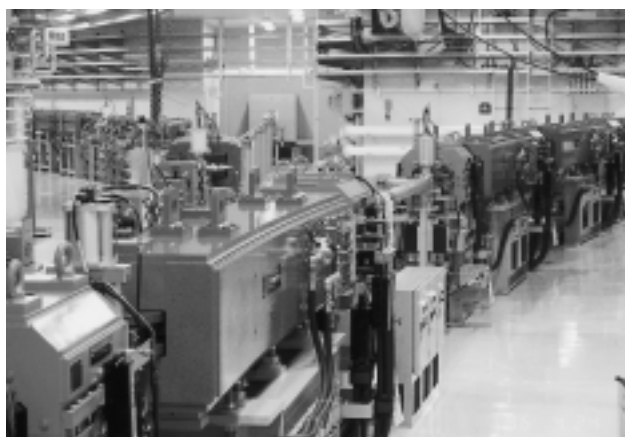
シンクロトロン出射部 (シンクロトロンで加速した8 GeVの電子ビームを蓄積リングに運ぶビーム輸送系)
