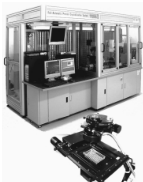
タンパク質の大量高速解析事業を可能とする ハイスループットファクトリー（放射光結晶解析を 使ってタンパク質の立体構造を決める）
