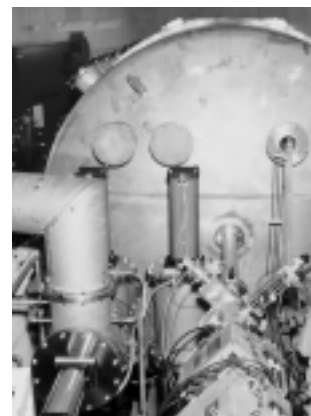
核反応で放出される荷電粒子を捕まえる大散乱槽“阿修羅；ASCHRA”
