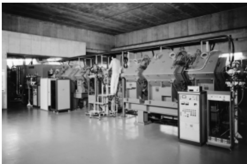
新しく生まれたばかりの高エネルギーの生成核種を直接的に捕まえる核反応生成核種分離装置“RIPS”（重イオン科学の要となる装置）
