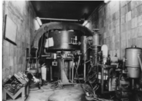
第1号サイクロトロンの子備の電磁石を使って再建した第3号サイクロトロン（電磁石の大きさは65センチメートル、破壊を免れた部品を集め、医療用短寿命RIの製造や高分子の中性子効果などの研究に活用）
