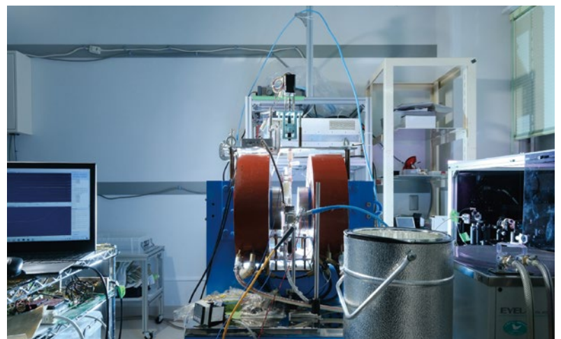
図2 水の核スピンの発生と測定を行う実験装置
