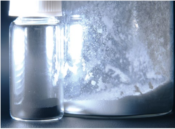
図3 焼成前の理研 MOF（右）と焼成後に粉碎した理研 MOF 炭化物（左）
