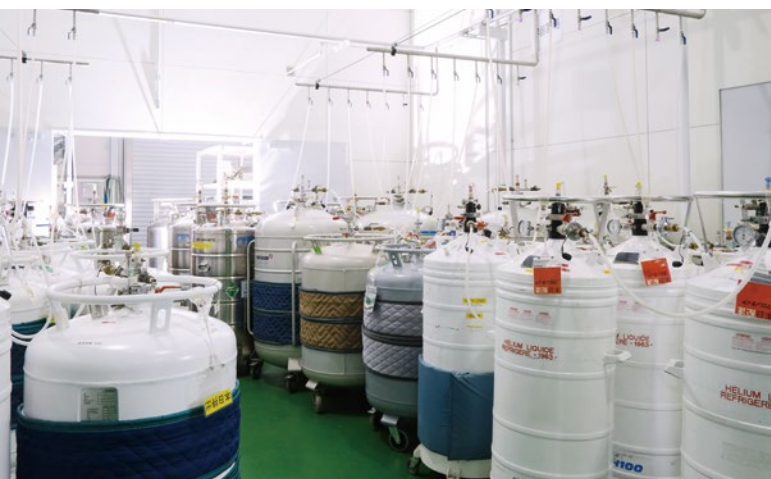
図2 リサイクルされ、再度配給されるのを待つ液体ヘリウム
