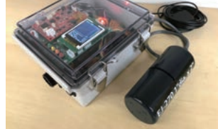
図3 月面の水資源探査用に開発している中性子測定器
