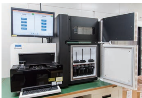
DNAを増幅するために、一定量（数μL）の試薬を正確に分注する装置。
