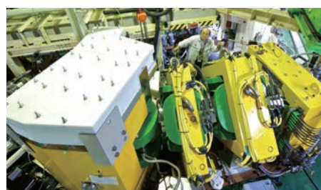
119番・120番元素の合成に使用される気体充填型反跳分離器GARIS-II
