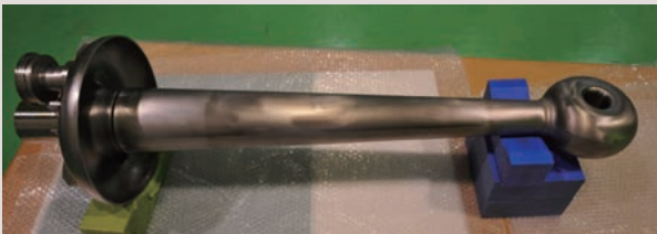
ステム（内導体）と天板を溶接
