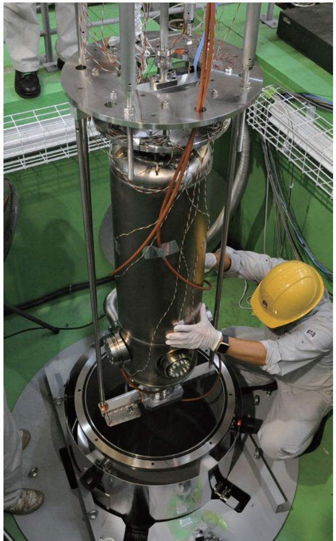
図12 超伝導加速空洞の性能試験
