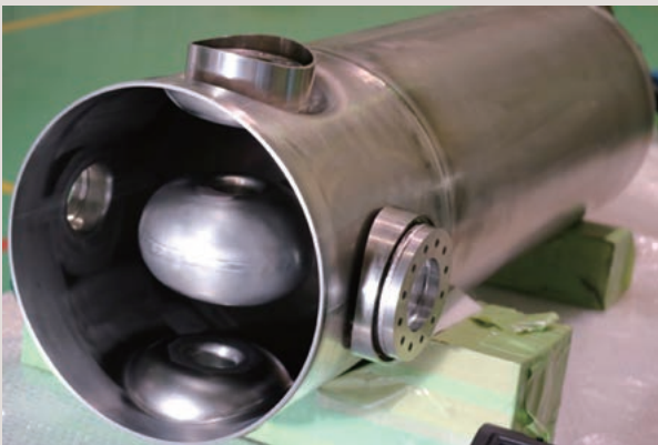
ステムと外導体を溶接
