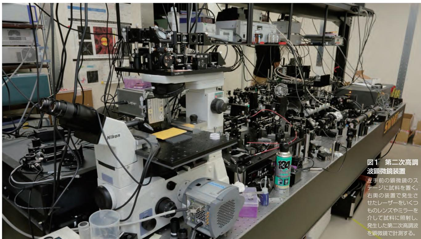
図1 第二次高調波頭微鏡装置
