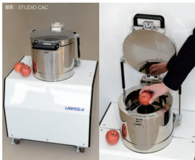
図1 食品放射能測定装置LANFOS
