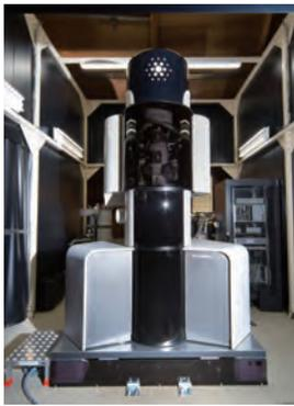
図4 タンパク質構造解析用に導入した電子顕微鏡
