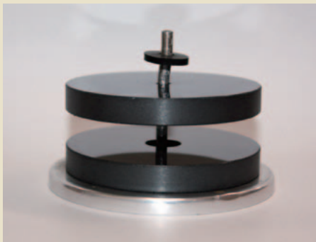
写真3 BBK (バリウム・ビスマス・科研) 浮き磁石フェライト 磁石を浮上させたもの。
