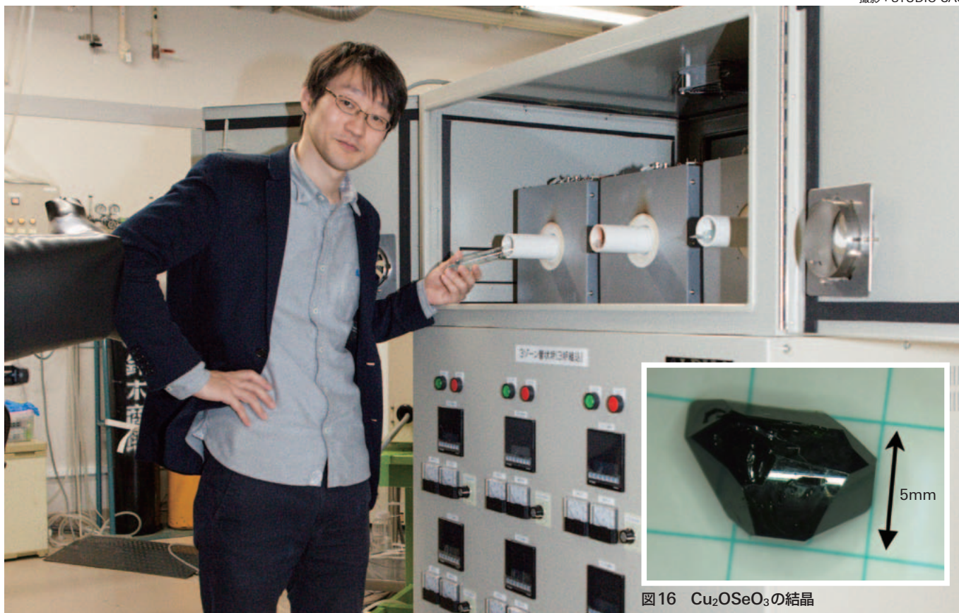
図15 スキルミオンを生成できる絶縁体 \text{Cu}_2\text{OSeO}_3 をつくり出した装置と関 真一郎ユニットリーダー
