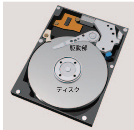
図10 ハードディスク 駆動部の先に付けられた磁気ヘッドで磁区の磁化の向きを操作して情報を書き込む。駆動部があるため書き込み速度に限界があり、衝撃に弱い。
