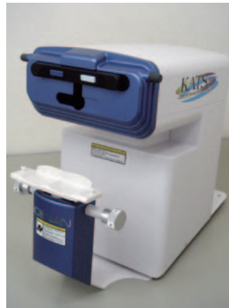
図2 水晶体の硬さを測定する装置と結果表示画面のイメージ
