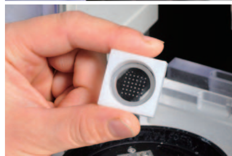
図2 タンパク質チップ診断システム チップに血液(分離血清)を数滴垂らして装置にセットすると、約15分後に右側のパソコン画面に検査結果が表示される(図3)。
