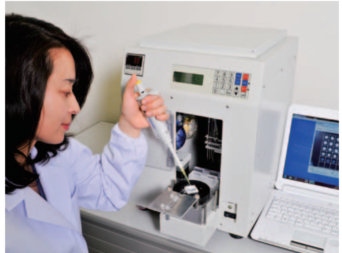
図2 タンパク質チップ診断システム チップに血液(分離血清)を数滴垂らして装置にセットすると、約15分後に右側のパソコン画面に検査結果が表示される(図3)。
