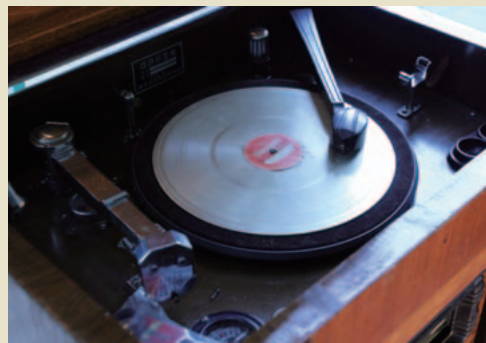
写真2 プレーヤー部 （上ぶたを開けた状態） 左側アームが録音用、 右側アームが再生用。
