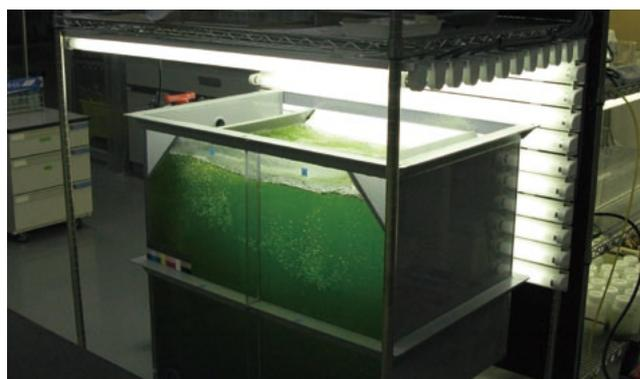
**図2** ヒョウタンゴケ原糸体を液体培養する400リットルの装置
