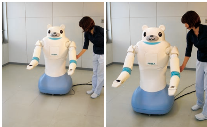
図3 触覚による操作 RIBAの腕は高感度の半導体センサによって覆われている（左）。人が腕に直接触れて、目的の場所まで移動させたり、抱き上げるときの腕の形や動きを指示することができる。
