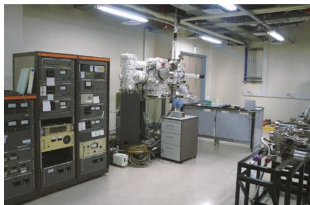
**図2** FRS時代に理研で開発した有機分子線エピタキシー（OMBE）システムをFTCの実験室に移設再稼働
