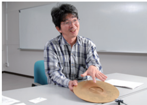
図1 高周波カーペット電極を手にする和田道治 先任研究員 電極には電場のバリアを形成するための細かいリング電極が同心円状に0.3mm間隔で刻み込まれている。その中心に開いた小さな穴からイオンを真空中へ導き出す。
