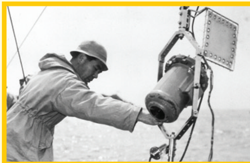
写真2 鳴門海峡海底調査に用いられた水中カメラと渡辺精一
