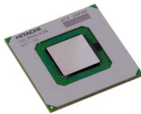
図1 MDGRAPE-3チップ チップの半導体部分の大きさは15.7mm角。日立製作所のHDL4N（130nm）製造技術で製造。
