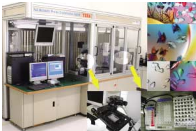
図2 自動結晶化・観察ロボットシステム「TERA」
