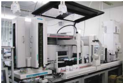
図2 自動結晶化・観察ロボットシステム「TERA」
