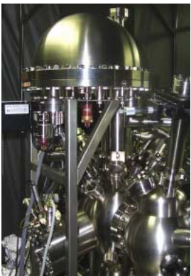
図2 超高真空表面分析システム
