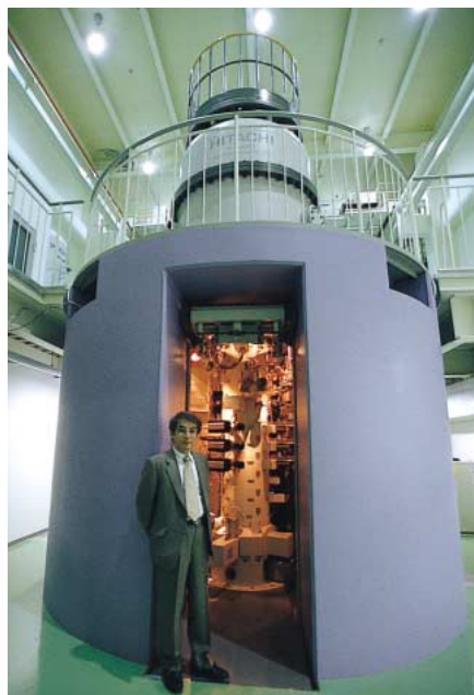
図6 1MVホログラフィー電子顕微鏡の本体部と外村彰チームリーダー
