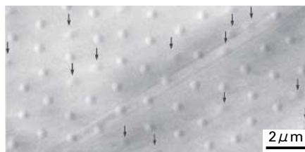
図8 ビスマス系高温超伝導体Bi-2222薄膜中の磁束量子
