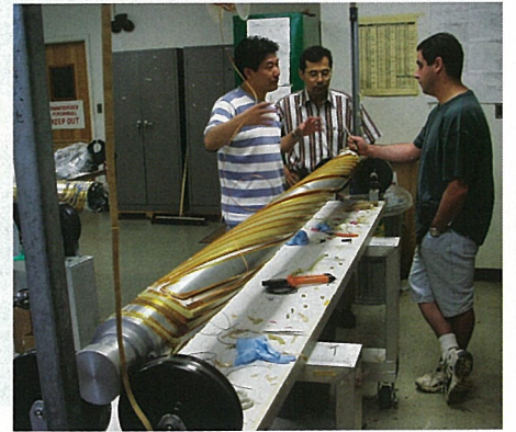
図⑤：製作途中のサイベリアン・スネーク電磁石
