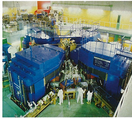
図④：理研で稼働中のRRC 装置直径12.6m、総重量2100トン
