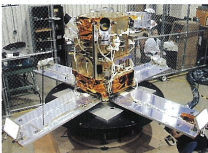
慣性モーメントを測定中のHETE-2衛星
