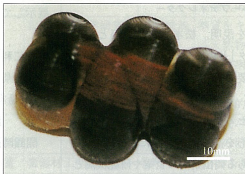
光造形方式により作製した着色分子模型： 積層厚さ0.2mm、作製時間約5時間
