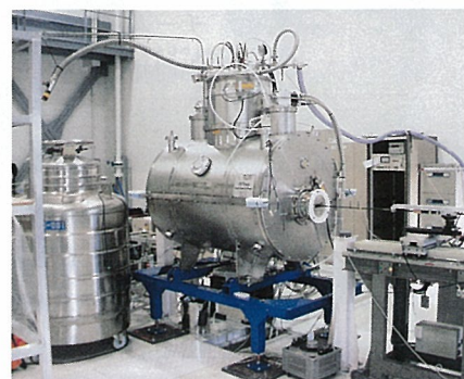
世界最高磁場を達成した超伝導ウィグラー
