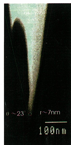
図3 2本、3本のチップをもつSTMにおいては、チップ先端が極めて鋭いことが重要である。これは先端の曲率半径が約7nmの鋭いチップ。
