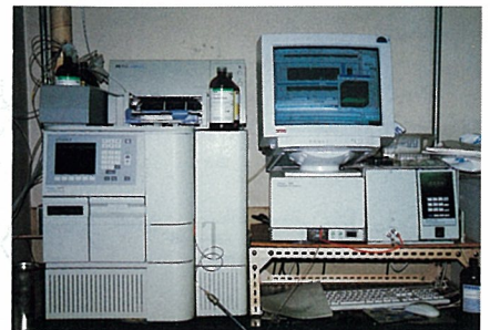
精製困難なサンプルはHPLCによって分離する
