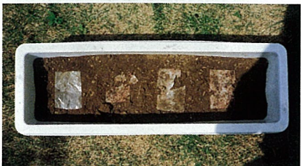
環境での分解実験。夏に4週間、土の中に埋めておき、微生物によって分解・消化されたバイオプラスチックのフィルム
