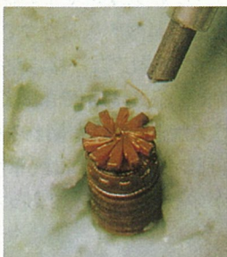
ポリイミド樹脂によるプロペラ形状の加工
