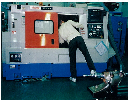
ラピッド・プロトタイプングシステム用のターニングセンター(NC加工機)
