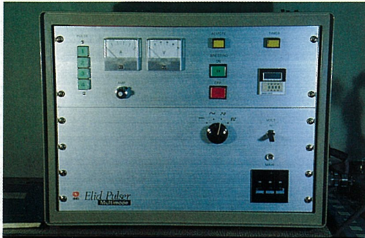
図4 ELID鏡面研削を実現する電解電源 〔新東プレーター(株)〕
