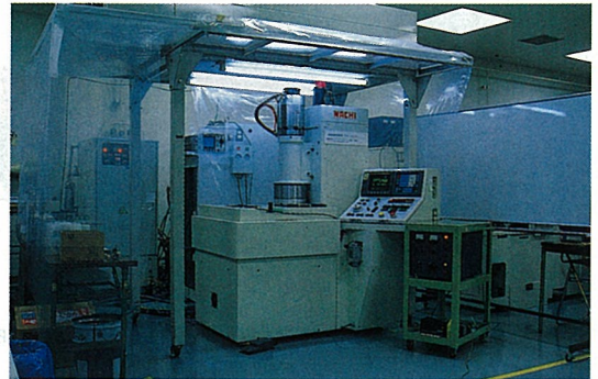
図5 実用化された超精密ELID鏡面研削盤 〔㈱不二越〕
