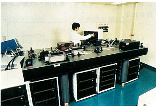
図5 小型軟X線レーザー励起用 ガラスレーザーシステム
